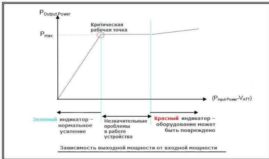
$P_{Output\ Power}$ : Выходная мощность
